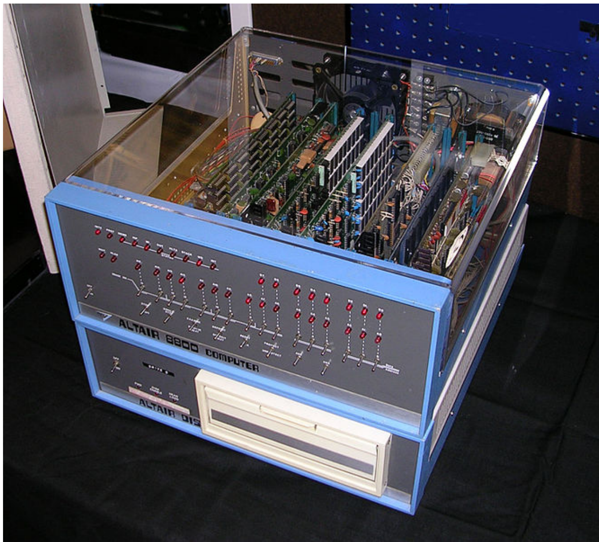
L'Altair 8800. On aperçoit le microprocesseur Intel 8080 sur la carte la plus à droite.
